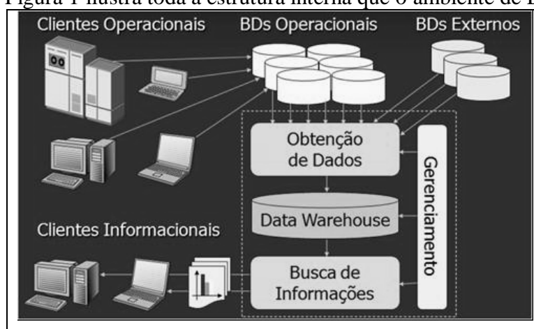
Figura 1 – Estrutura interna do DW
